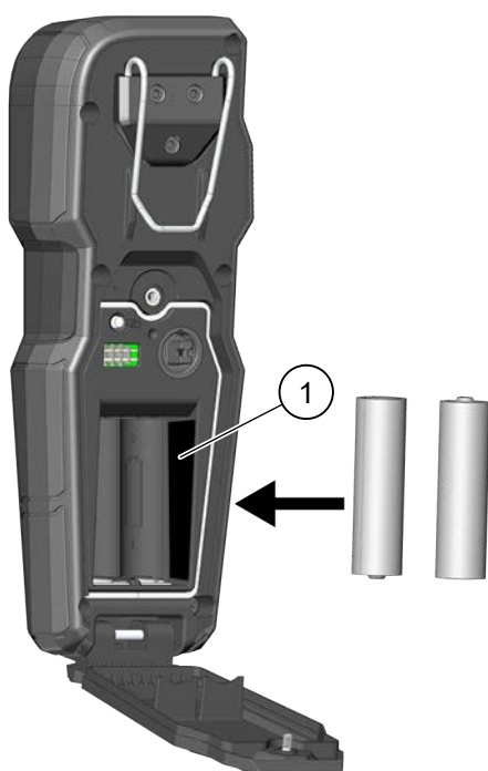
Figure 1. Installation des piles de la télécommande
